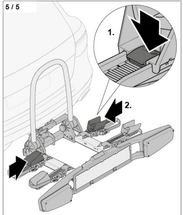
► Drücken Sie die Radaufnahmeverriegelung (1).
