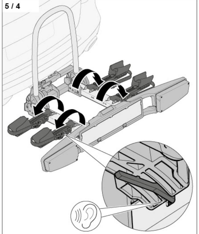
► Klappen Sie alle Radaufnahmen aus, bis diese einrasten.
