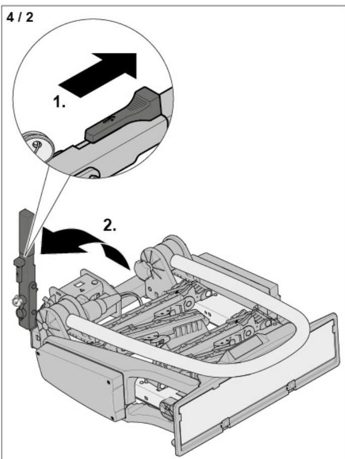
► Entriegeln Sie den Spannhebel (1).
