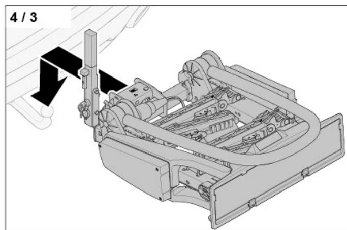
► Setzen Sie den Fahrradträger auf die Anhängerkupplung am Fahrzeug.
