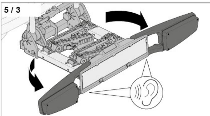
► Klappen Sie beide Leuchtenbügel aus, bis diese einrasten.
