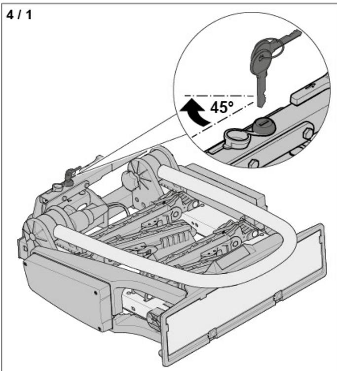
► Schließen Sie das Spannhebelschloss auf.
