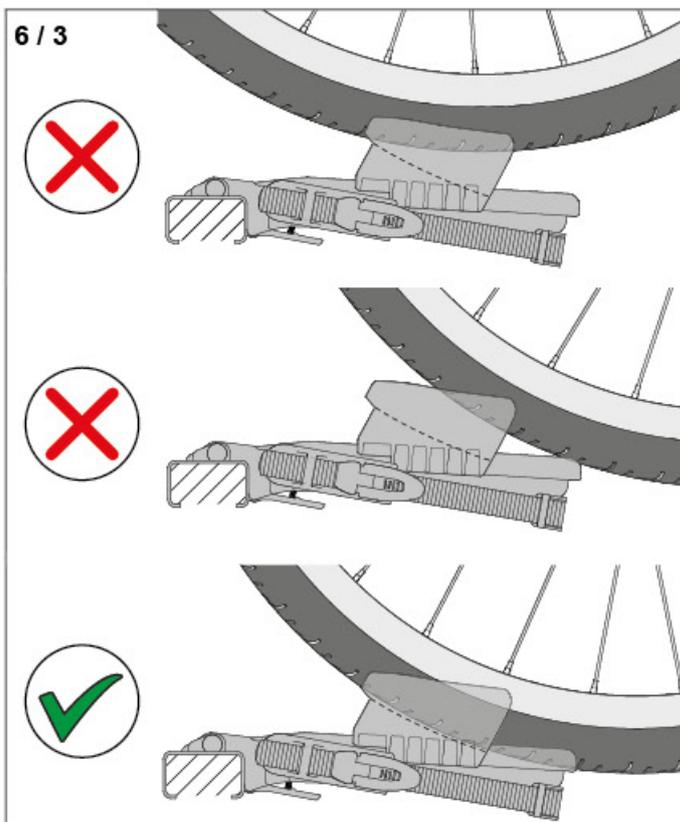
▶ Schieben Sie die Radaufnahmen an das Fahrrad.
